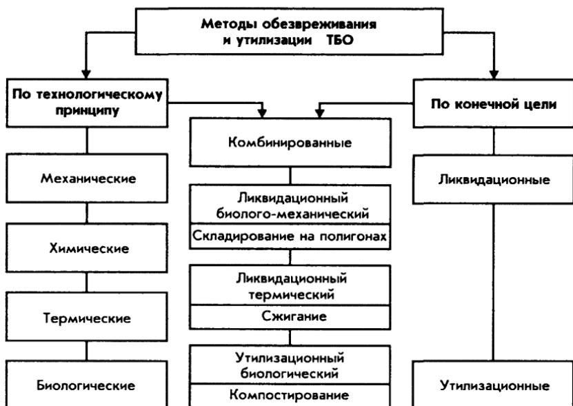
Рис. 4. Классификация методов обезвреживания и утилизации ТБО
